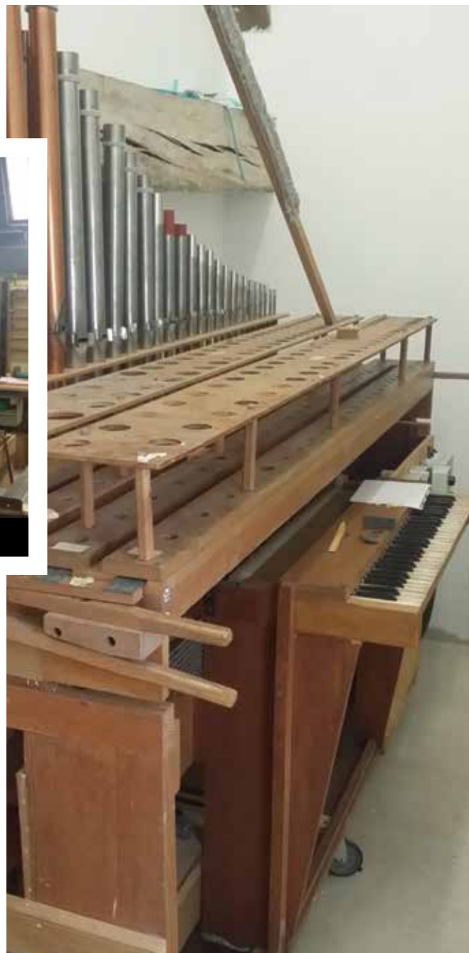
Mannequin : C'est l'orgue servant au travail de l'harmoniste en atelier. Le bon fonctionnement des tuyaux restaurés y est vérifié.
